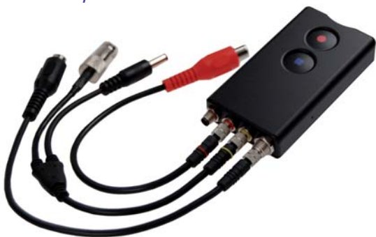
Ejemplo de un conjunto de cable i-Conex adaptado en la grabadora de video digital FlashBack-3-C de Ovation.
